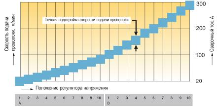
В синергетическом режиме управления скорость подачи проволоки выбирается автоматически.
