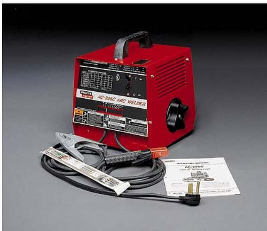
Бытовой сварочный трансформатор AC-225 компании Lincoln Electric применяется для ручной дуговой сварки штучными электродами. Широкий диапазон регулировки сварочного тока - от 40 до 225А позволяет сваривать материалы толщиной от 1,52 мм и выше из углеродистых, низколегированных и нержавеющей сталей, а также чугуна. Сварка осуществляется на переменном токе.
