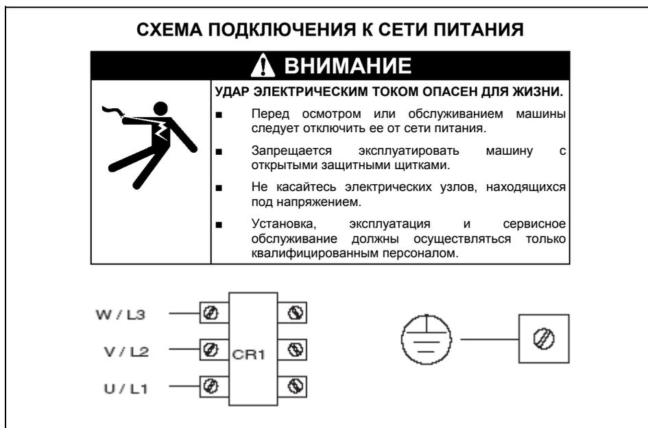
**РИСУНОК А.1 - СХЕМА ПОДКЛЮЧЕНИЯ, РАСПОЛОЖЕННАЯ НА ВНУТРЕННЕЙ СТОРОНЕ КРЫШКИ РАСПРЕДЕЛИТЕЛЬНОЙ КОРОБКИ**
