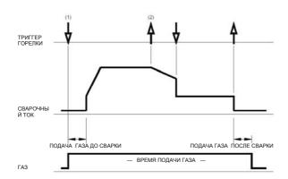
Как показано выше, возможно повторное нажатие и удержание кнопки горелки на этапе спада сварочного тока с рабочего значения до тока заварки кратера. После отпускания кнопки источник отключит выходное напряжение и начнется стадия послесварочной подачи газа.
