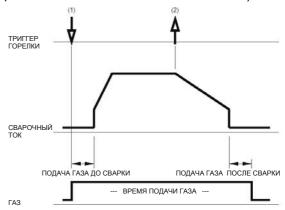
1. Нажмите и удерживайте кнопку горелки для аргонодуговой сварки. При этом откроется газовый клапан, и начнется этап предварительной подачи защитного газа. По истечении 0,5 с, необходимых для продувки газового тракта, начнется подача напряжения на выход сварочного источника. Дуга возбудится в соответствии с выбранным способом зажигания (точечным касанием или высокочастотным возбуждением). Подробно способы зажигания дуги описаны выше в главе "Переключатель сварочных режимов".
