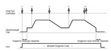
1. Нажмите и удерживайте кнопку сварочной горелки. При этом откроется газовый клапан, и начнется этап предварительной подачи защитного газа. По истечении 0,5 c. необходимых для продувки газового тракта, напряжения на начнется подача выход сварочного источника. Дуга возбудится в соответствии выбранным способом С (точечным касанием или с зажигания помощью осциллятора). Подробно способы зажигания дуги описаны выше в главе "ПЕРЕКЛЮЧАТЕЛЬ СВАРОЧНЫХ РЕЖИМОВ".
