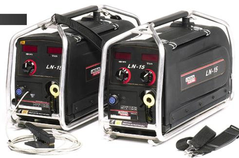
Механизм подачи LN-15 поставляется двух моделей: с зависимой (питание от напряжения дуги) и независимой (с кабелем управления) системой подачи сварочной проволоки. Обе модели применяются для полуавтоматической сварки, в том числе импульсной, обычных и нержавеющей сталей, алюминиевых и других сплавов.
