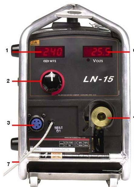
5. Регулятор напряжения дуги
