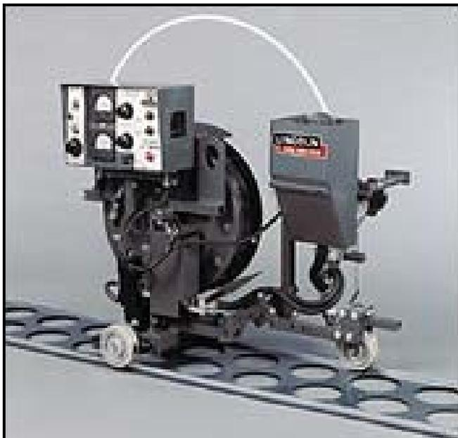
LT-7 – самоходное подающее устройство для автоматической сварки под флюсом с приводом постоянного тока и возможностью установки на направляющие рельсы (трек).
