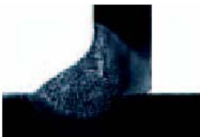
Сварка на постоянном токе положительной полярности 527 А
